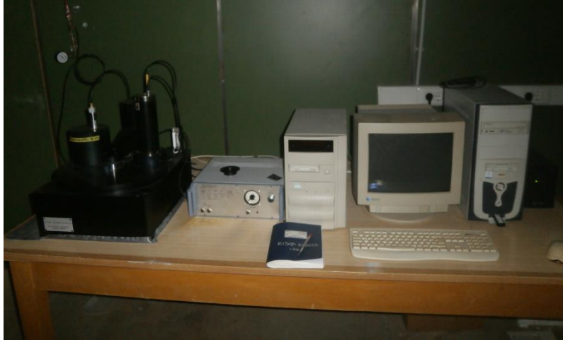
Εικόνα 3: Διάταξη ΟΔΦ του Εργαστηρίου Αρχαιομετρίας του Ε.Κ.Ε.Φ.Ε. «Δημόκριτος».
