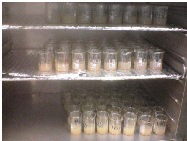
Εικόνα 9: Ξήρανση στον κλίβανο σε θερμοκρασία 50 °C.
