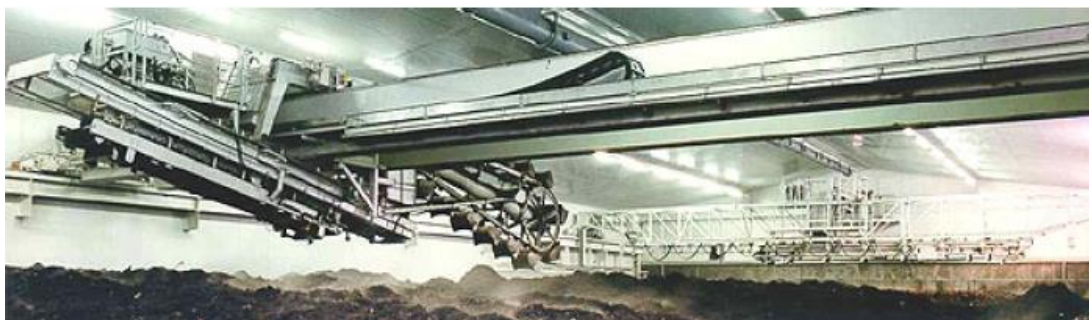
Εικόνα 17: Σύστημα κομποστοποίησης σε τράπεζα
