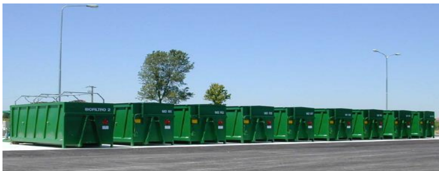
Εικόνα 16: Σύστημα κομποστοποίησης σε κοντέινερ
