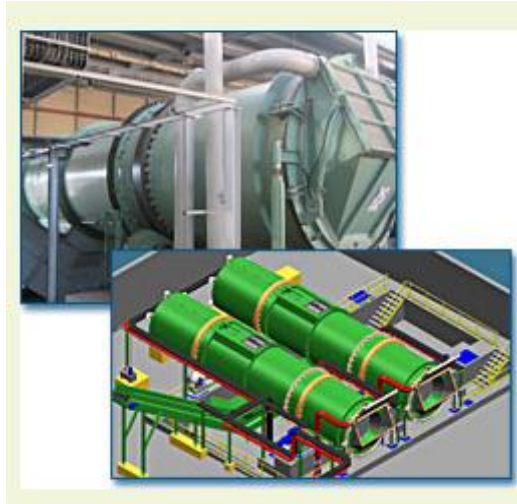
Εικόνα 18: Σύστημα κομποστοποίησης σε περιστρεφόμενους βιοαντιδραστήρες
