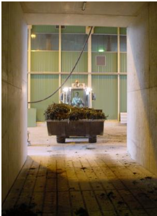
Εικόνα 15: Σύστημα κομποστοποίησης σε βιοκελιά
