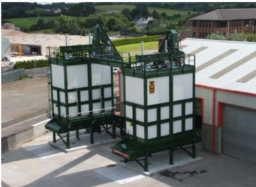
Εικόνα 13: Κάθετα συστήματα κομποστοποίησης
